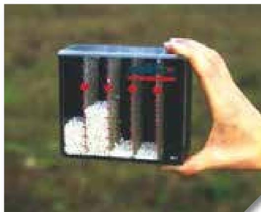
Le granulomètre permet une évaluation visuelle rapide de l'homogénéité de l'engrais et de son diamètre moyen
