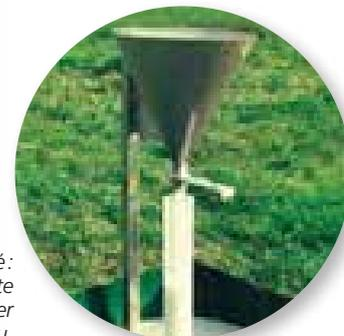
Mesure simple de la densité: remplir une éprouvette de 1 litre sans tasser et peser son contenu.
