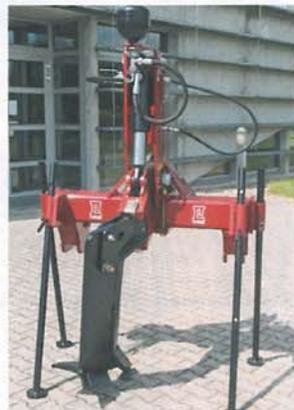
outil – en chassant quatre goupilles. L'attelage avant Laforge bénéficie d'un amortisseur par boule d'azote. Il est doté d'une course de 650 mm et dispose d'une capacité de levage de 3t.
