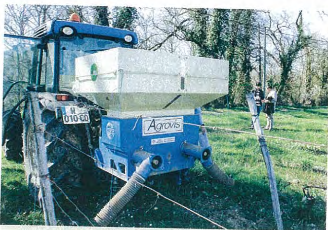
AVEC SON SYSTÈME D'ÉPANDAGE À VIS DIRIGÉ, l'amendement organique profite directement au pied du cep.
