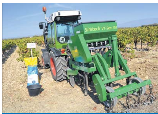
Second matériel présenté lors de cette journée : le semoir direct de Simtech Aitchison, permettant d'intervenir dans un sol déjà couvert.
