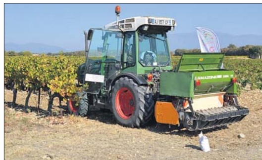
Sébastien Rousson a présenté un semoir classique composé d'un décompacteur, d'une herse rotative, d'un semoir et d'un rouleau.
